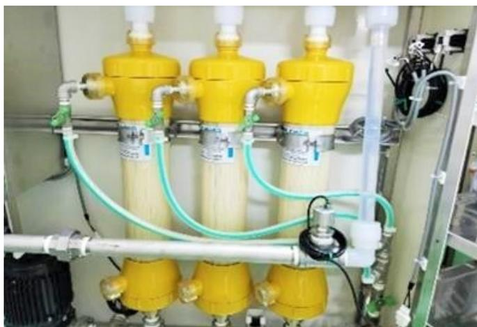
透析液供給装置出口部へ設置する
