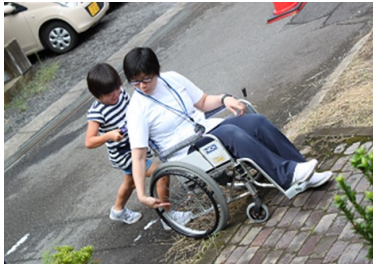
▲ ティッピングバーを踏み、前輪を上げ段差を越えます
